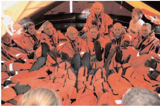
Abb. 1: Maximaler Beladungsversuch Rettungsinsel
